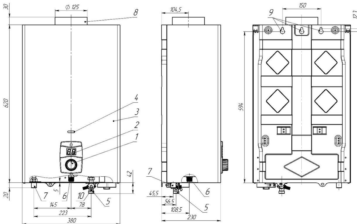
Рисунок 16. Габаритные и присоединительные размеры аппарата «NEVA 5514E»
