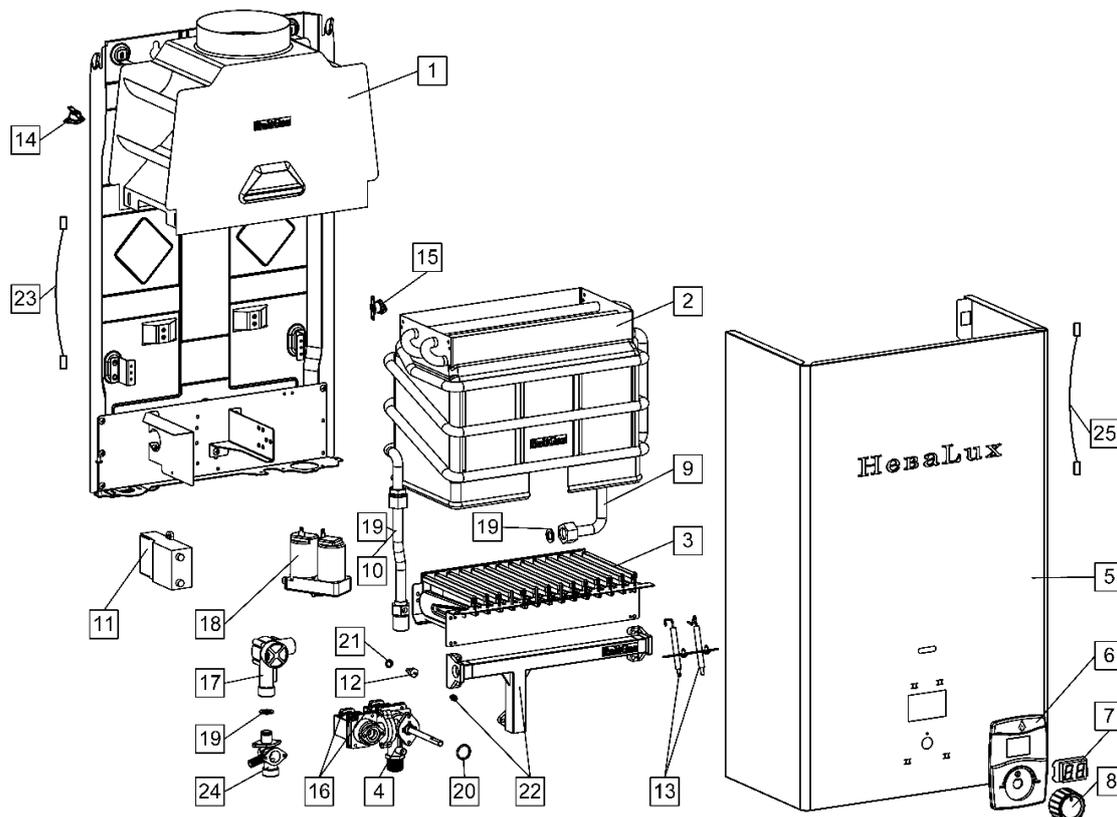
Рисунок 116. Вид аппарата «NEVA 5514E» с разнесёнными частями
