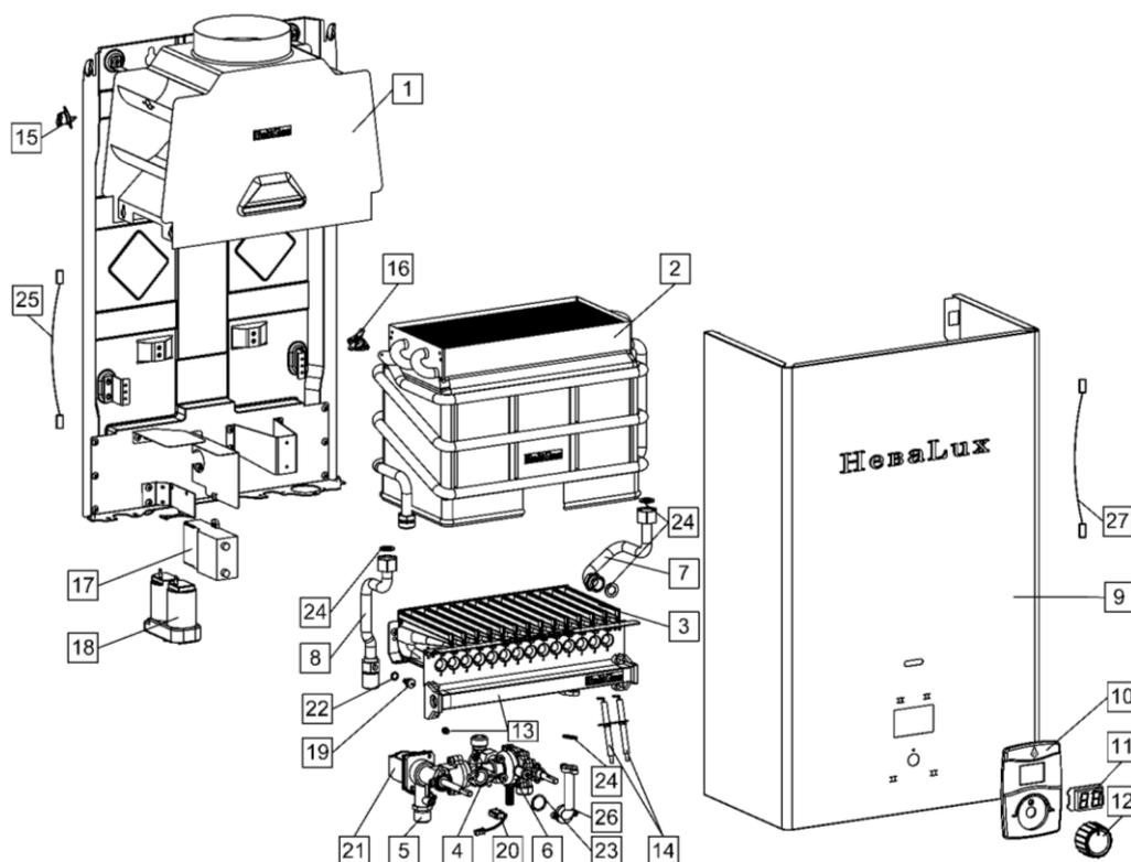
Рисунок 11а. Вид аппарата «NEVA 5514» с разнесёнными частями
