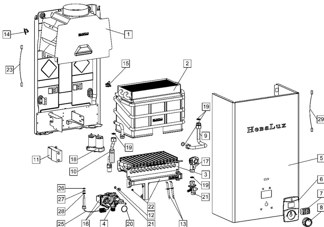
Рисунок 11в. Вид аппарата «NEVA 5514M» с разнесёнными частями
